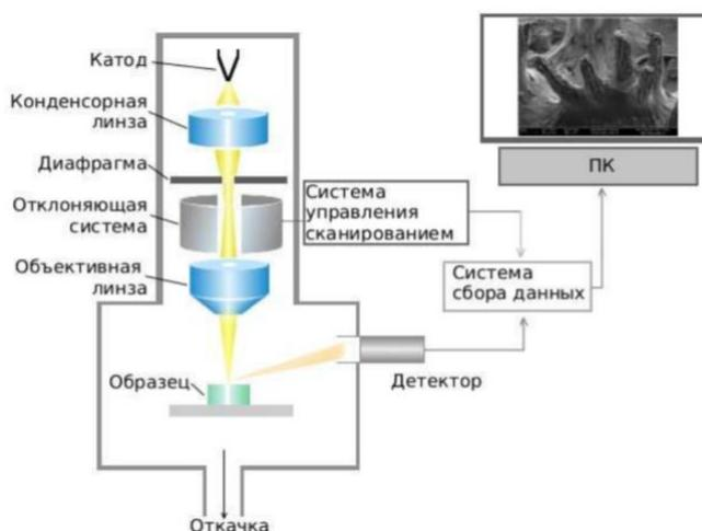
Рисунок 3 – Схема СЭМ [11]
