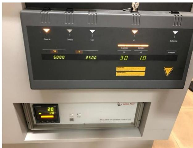
Рисунок 23 – Заданные параметры силы тока и напряжения
