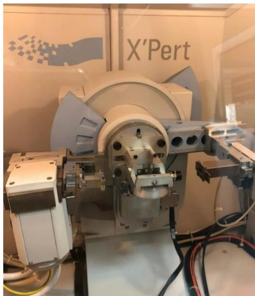
Рисунок 20 – Дифрактометр XPERT
