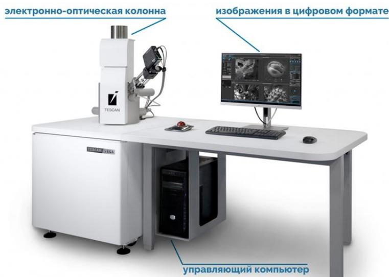
Рисунок 2 – Внешний вид сканирующего электронного микроскопа [10]
